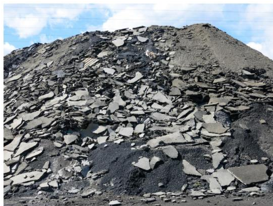
MYND 2 Dæmi um safnhaug með blöndu af malbiksflákum, fræstu malbiki og afgangsmalbiki (KFA, 2019).
